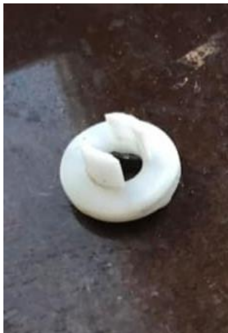
Losstagen trasig hondel till koppelhaken.
